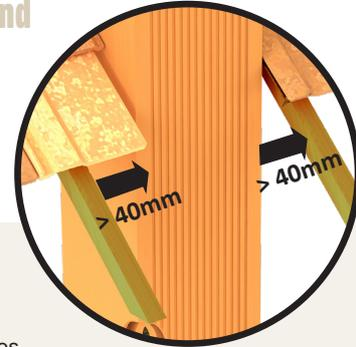
40 mm zwischen der Außenwand des Rauchabzugs aus Ton und allen Brennmaterialien des Bauwerks. (gemäß NF EN 15287-1)
