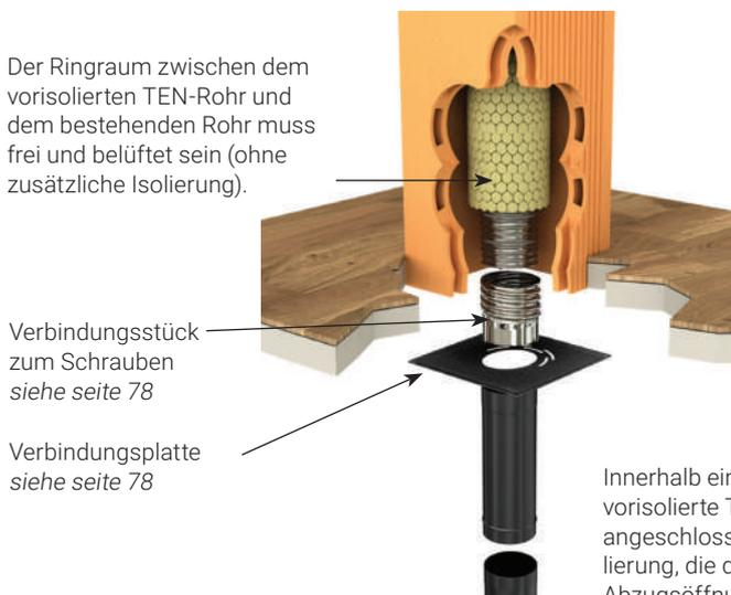
Innerhalb einer Abzugsöffnung kann das vorisolierte TEN-Verfahren direkt an das Gerät angeschlossen werden, wobei die Steinwollisolierung, die den Metallschlauch umgibt, in der Abzugsöffnung belassen werden kann.
